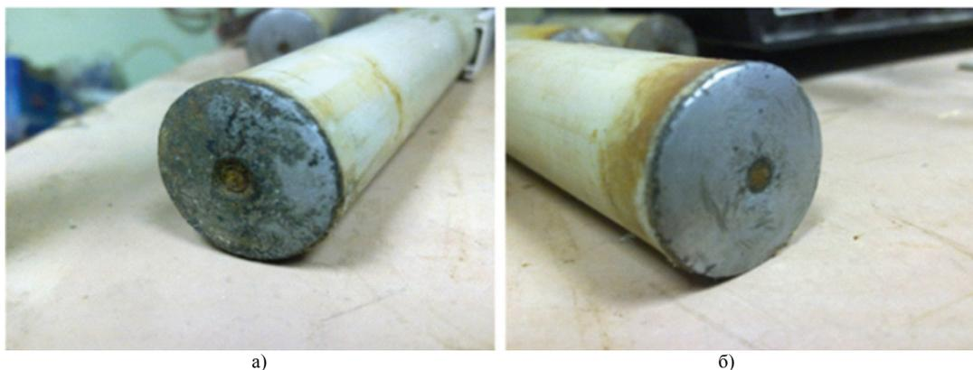
Рис. 7. Изменение вида поверхности металлических образцов без воздействия переменного тока (а) и после активации поверхности переменным током (б)
